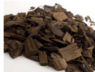
Torrefied wood, brandstof voor entrained flow-vergassers voor de productie van syngas/biobrandstof.
